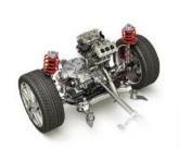
动力系统、变速箱、分动器、 差速器、双质量飞轮、制动器、 防抱死系统、传动轴、车轴、 减震器导向套、悬架
